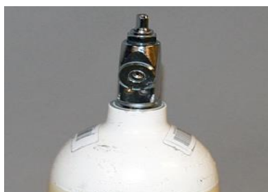
Reduktionsventil tilhørende iltflaske med 3/4 tomme gevind
